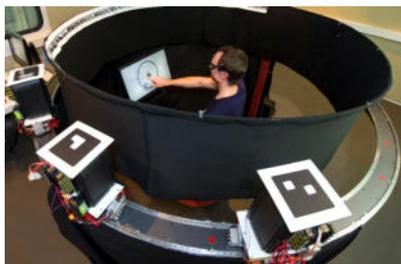
Bei dem Projekt «Robotic Sound Field Audiometry» geht es darum, die räumliche Hörfähigkeit und die Sprachverständlichkeit im Lärm von Patienten mit Hörgeräten oder Implantaten zu testen. Dazu wird ein Lautsprecher-Setup verwendet, mit dessen Hilfe die Schallquellen auf einem Kreisbogen konzentrisch um den Patienten bewegt werden können. Durch das technische Update, bei dem
