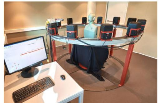
Hören ist auch im Strassenverkehr wichtig. Mit dem Umbau besteht erstmals die Möglichkeit, die Hörfähigkeit von Patienten mit Hörhilfen in einer dynamischen Schallfeld-Audiometrie zu testen.
